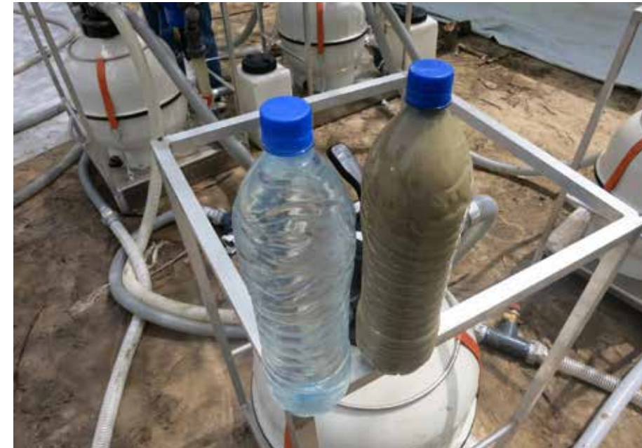
Flaskene er fylt med vann fra før og etter vannrenseenheten var i drift.
